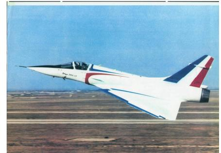
Les vols d'essais ont permis d'identifier le profil de vol le plus susceptible de provoquer le phénomène : pratiquer de fortes incidences, avec le moteur au plein gaz, après avoir volé de façon prolongée à fort nombre de Mach (conséquence de l'échauffement cinétique que subit la machine dans ces conditions). Ils nous ont aussi permis de classer les moteurs du parc dont nous disposons, selon leur sensibilité au phénomène.
